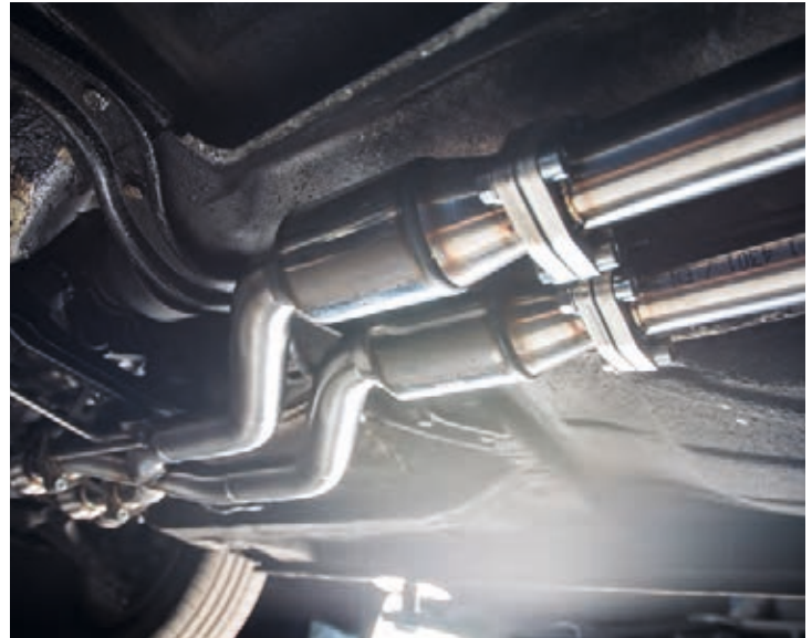
B Symmetrischer Kat-Anschluss-Konus mit Lambda-Anschluss Symmetric cat connection cone with connection for Lambda sensor
